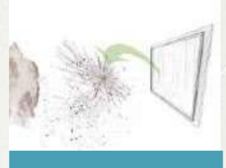
4. 負相の爆発波がガラス及び破片を爆発方向へ引き戻す
