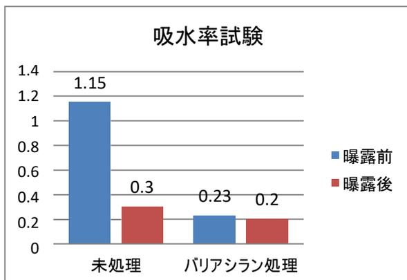
試験結果: 曝露6年後においても吸水抑制効果の低下は認められませんでした。(実験継続中)
