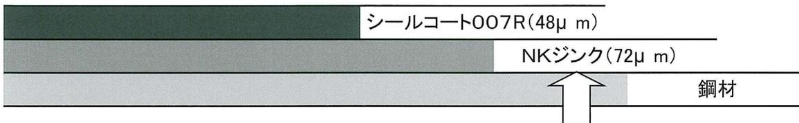
素地調整:ブラスト処理(ISO-Sa2 1/2)、パワーツール処理等
